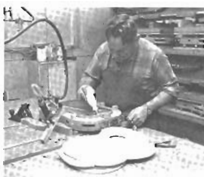
Lock och botten limmas fast vid sargen.
