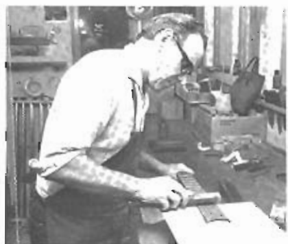
Greppbrädet finjusteras före slutmonteringen.
