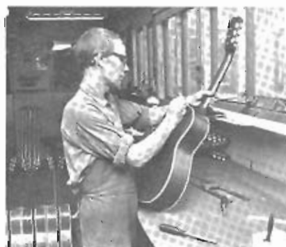
Infästning av gitarrens hals är ett av fabrikenens viktigaste moment.
