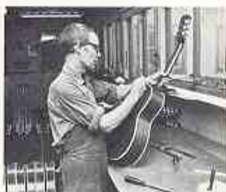
Infrysning av gitarrens hals är ett av förberedande viktigaste moment.
