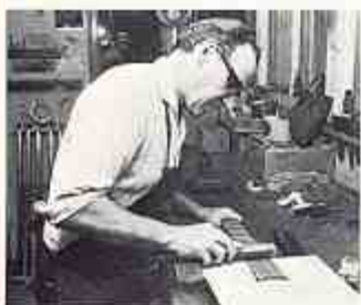
Greppbrädans fingertenns får slutmonteringen.
