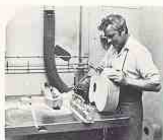
Spåret för bänningsslaget skärs ut med ett specialverktyg.
