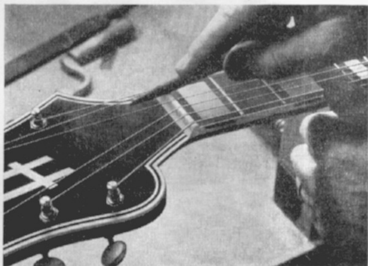
Justering av strängarnas läge i sadeln
