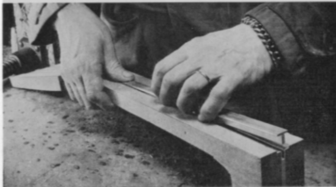
Insättning av T-balkförstärkning
